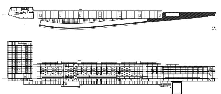
Grundriss: Das 240 Meter lange, horizontal orientierte Gebäude nimmt in der Form die gegebene Topografie auf. Gegen Norden, parallel zu den Schienen, verläuft die gerade Seite des Gebäudes, die Südseite, elegant geschwungen, folgt der Rue Crêt-Taconnet stadtwärts gerichtet. Das BfS 2 bildet den Kopf des Gebäudezuges.
