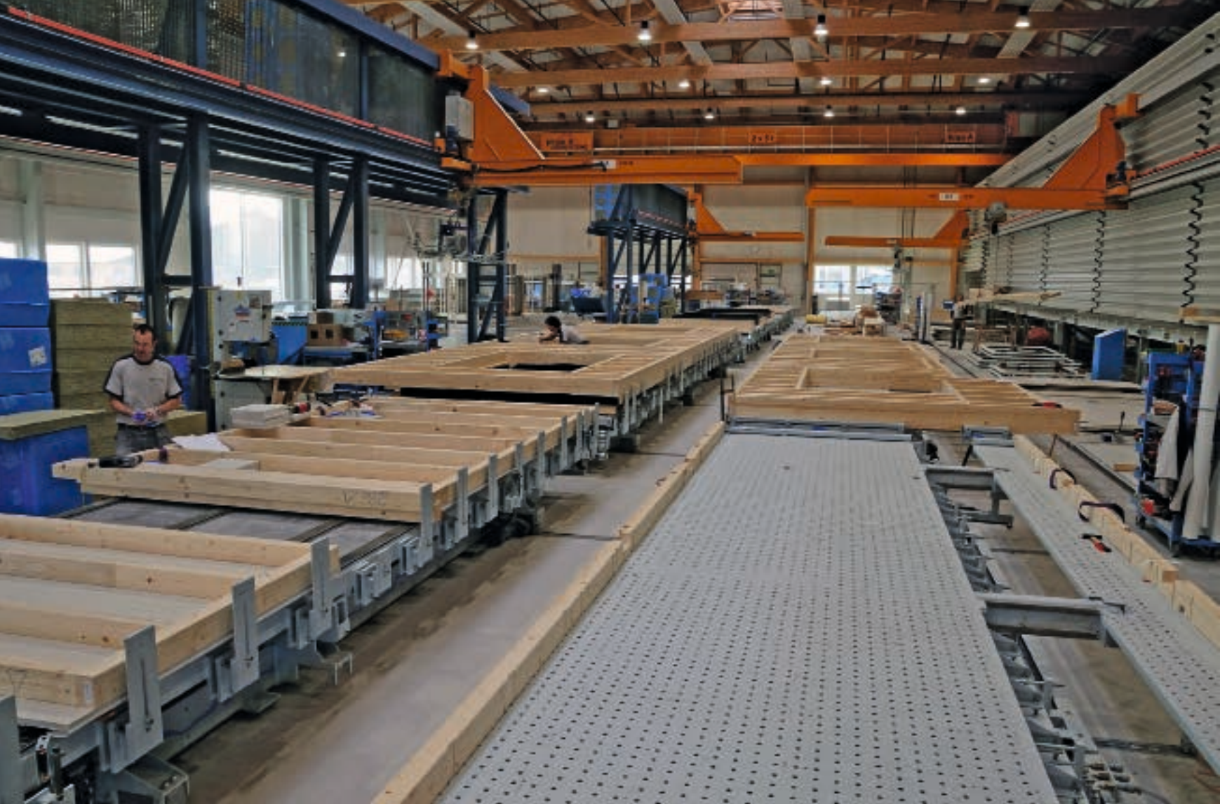
Nach der industriellen Vorfertigung ist das Gebäude auf der Baustelle in drei Wochen aufgerichtet.
