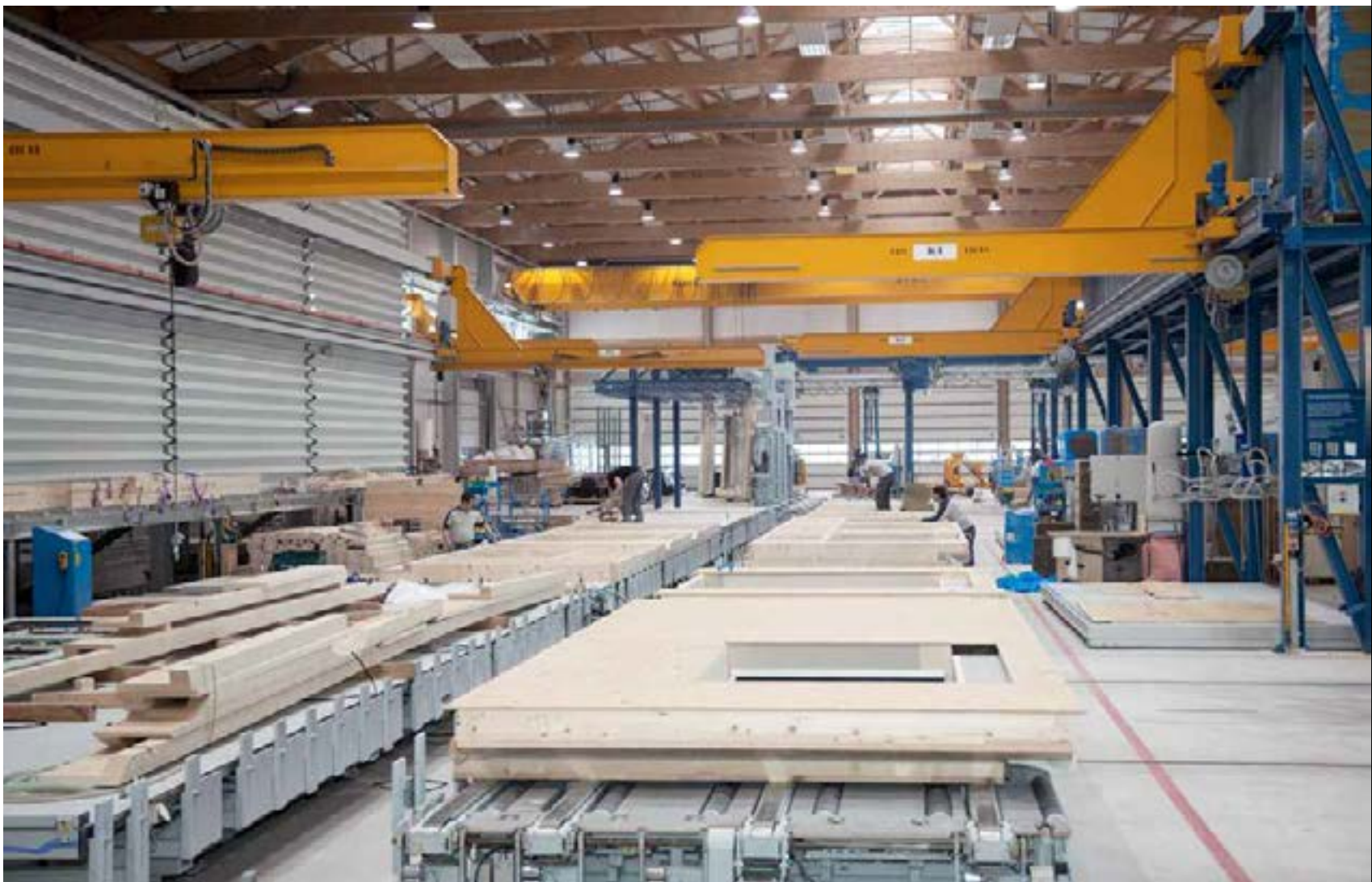
In der Halle der Holzbaufirma Renggli entstehen fixfertige Wand- und Deckenelemente. | Des éléments de mur et plafond prêts à l'emploi voient le jour dans l'atelier de l'entreprise de construction en bois Renggli.
