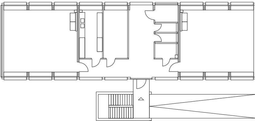
Erdgeschoss | Die zweite Generation bietet 10% mehr Fläche (10 statt 9 Module pro Geschoss)
