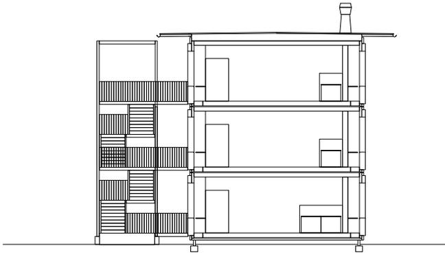
Querschnitt | Die Module können bis drei Geschosse aufgestockt werden
